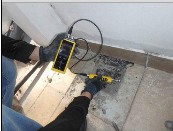
Fot. 04_5, 04_6. Pomiar wilgotności w pobliżu dolnej powierzchni szlichty 186,0 [digits] – przegroda mokra.
