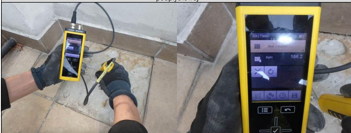
Fot 04_3, 04_4. Pod płytką szlichta cementowa niezabezpieczona izolacją podpłytkową. Pomiar wilgotności górnej powierzchni szlichty 186,2 [digits] – przegroda mokra.
