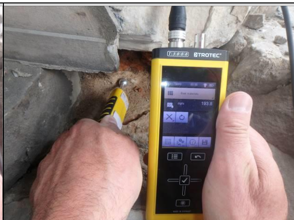
Fot_02_6. Pomiar wilgotności muru „na tynku” Tu odczyt 193,8[digits] – przegroda mokra.
