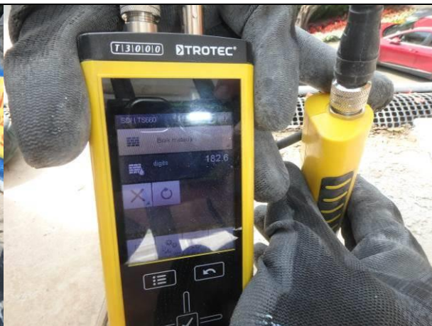
Fot. 05_3, 05_4). Zaprawa klejąca widocznie zdegradowana. Pomiar wilgotności górnej powierzchni kleju 182,6 [digits] – przegroda mokra.
