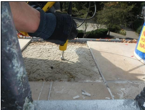
Fot. 05_3, 05_4). Zaprawa klejąca widocznie zdegradowana. Pomiar wilgotności górnej powierzchni kleju 182,6 [digits] – przegroda mokra.
