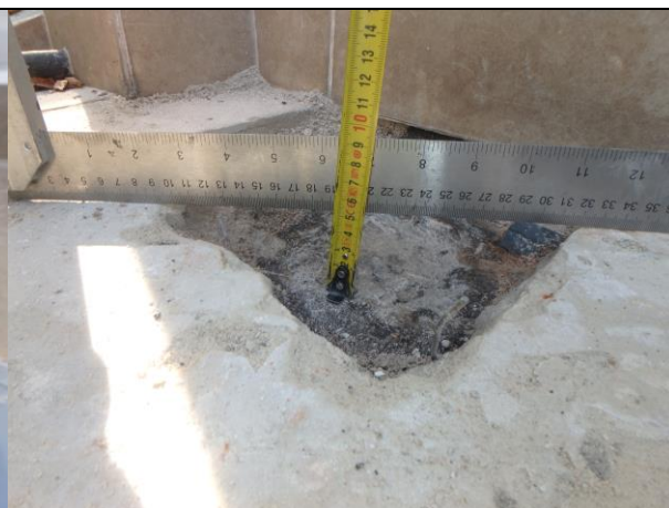
Fot 04_6. Pomiar grubości szlichty – 5,5cm.
