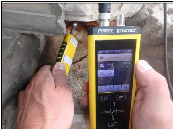
Fot_02_5. Pomiar wilgotności muru „na cegle” Tu odczyt 186,4[digits] – przegroda mokra.
