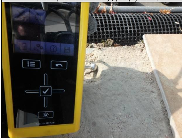
Fot. 05_7, 05_8). Pomiar wilgotności w pobliżu dolnej powierzchni szlichty 186,8 [digits] – przegroda mokra.
