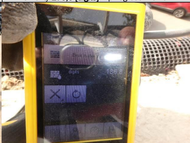
Fot. 05_7, 05_8). Pomiar wilgotności w pobliżu dolnej powierzchni szlichty 186,8 [digits] – przegroda mokra.
