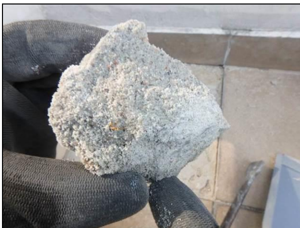
Fot 04_5. Przełom szlichty wyraźnie zawilgocony.
