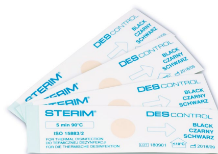
Test kontroli dezynfekcji termicznej 90°C 5 minut
