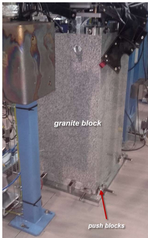
Rys. 4. Przykładowy system wsparcia komór próżniowych przy wykorzystaniu podpór granitowych.
