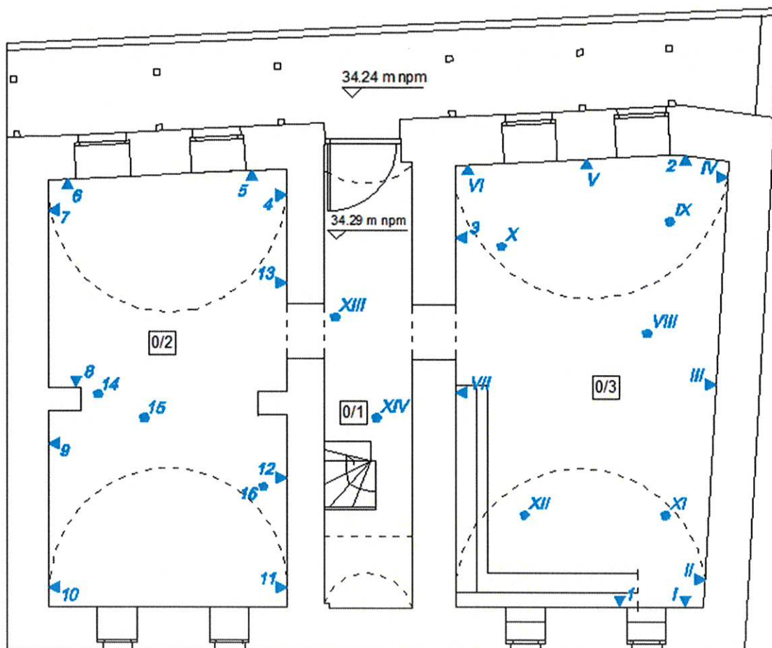
Tablica 1. Wyniki badań wilgotności ścian i posadzek w piwnicy
