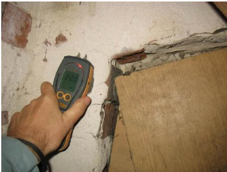
Fot.31 Zawilgocona ściana szczytowa. Odczyt 22 – wilgotność masowa ścian 6,2% zgodnie z punktem 4 opinii (czerwone wskazanie urządzenia)
