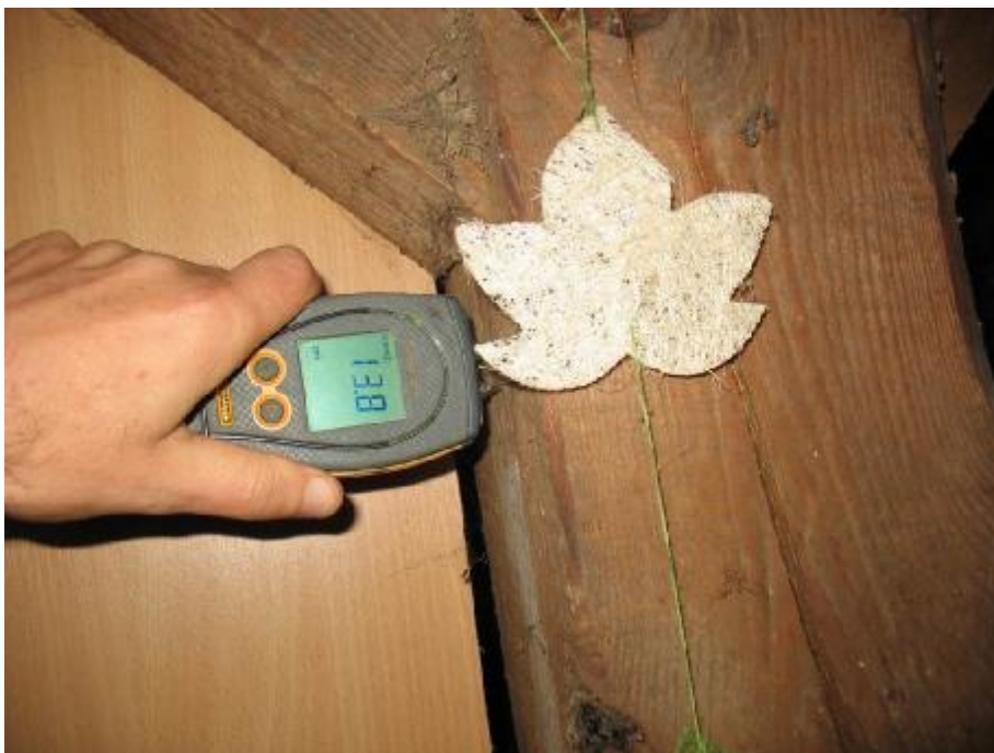
Fot.21 Badanie wykazało, że słup jest suchy. Odczyt 13,8 %<15% (wilgotność drewna w stanie powietrzno-suchym, zielone wskazanie urządzenia).
