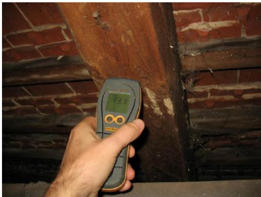
Fot.16 Badanie wykazało, że krokiew jest sucha. Odczyt 13,3 %<15% (wilgotność drewna w stanie powietrzno-suchym, zielone wskazanie urządzenia).
