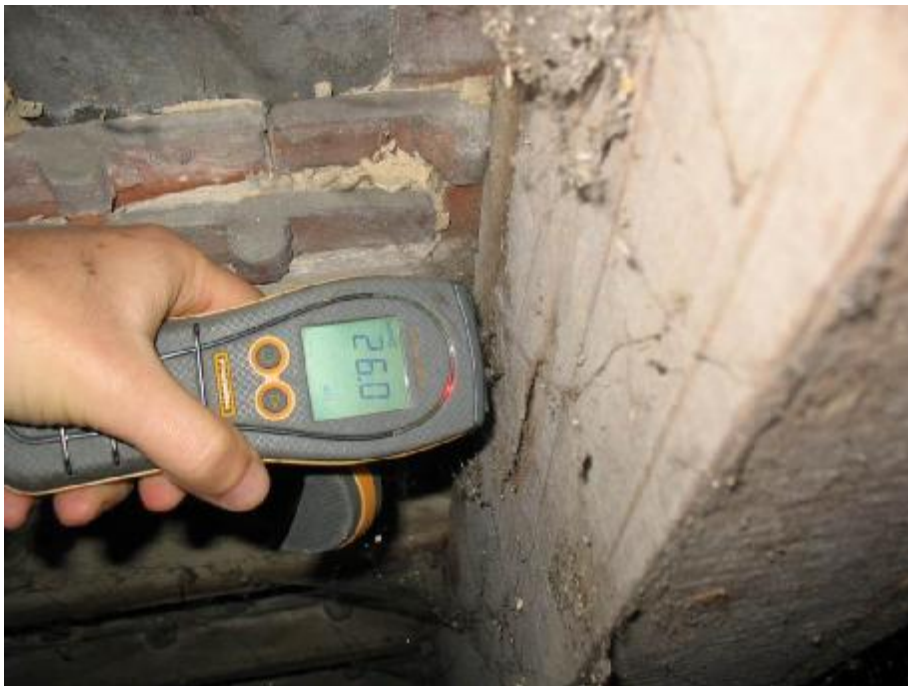
Fot.23 Badanie wykazało, że krokiew jest zawilgocona (czerwone wskazanie urządzenia) . Odczyt 26 %>15% (wilgotność drewna w stanie zawilgoconym, czerwone wskazanie urządzenia).
