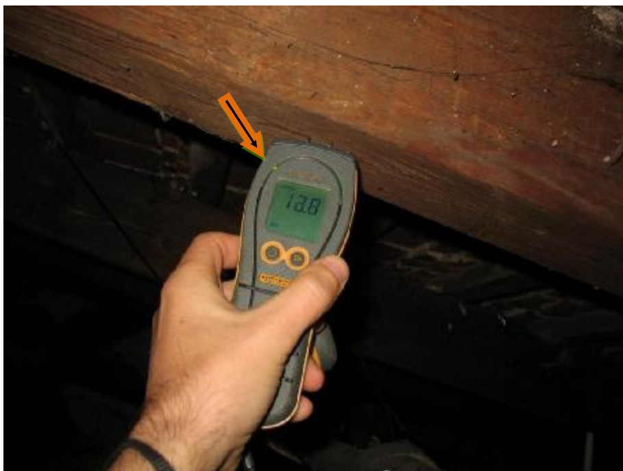
Fot.9 Krokiew (13x16)cm w stanie suchym. Odczyt 12,8 % < 15% (wilgotność drewna w stanie powietrzno-suchym, strzałka wskazuje zielone wskazanie).
