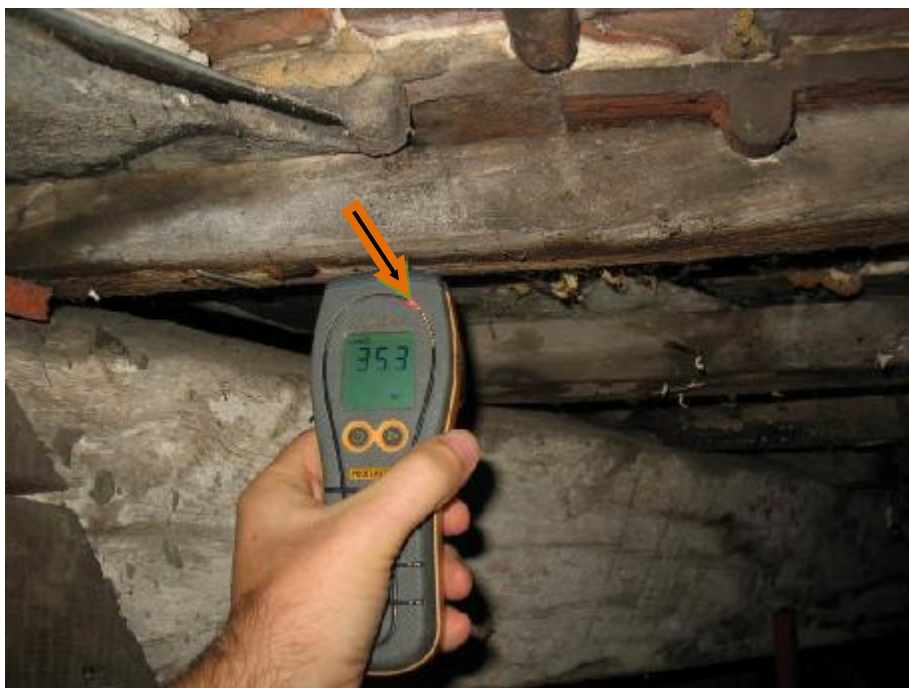
Fot.8 Łaty przy krokwi koszowej również posiadają ponadnormatywne zawilgocenie. (strzałka wskazuje czerwone wskazanie). Odczyt 35,3 % > 15% (wilgotność drewna w stanie powietrzno-suchym).
