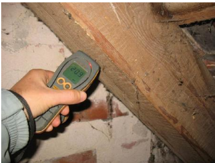
Fot.29 Badanie wykazało, że krokiew jest zawilgocona.
