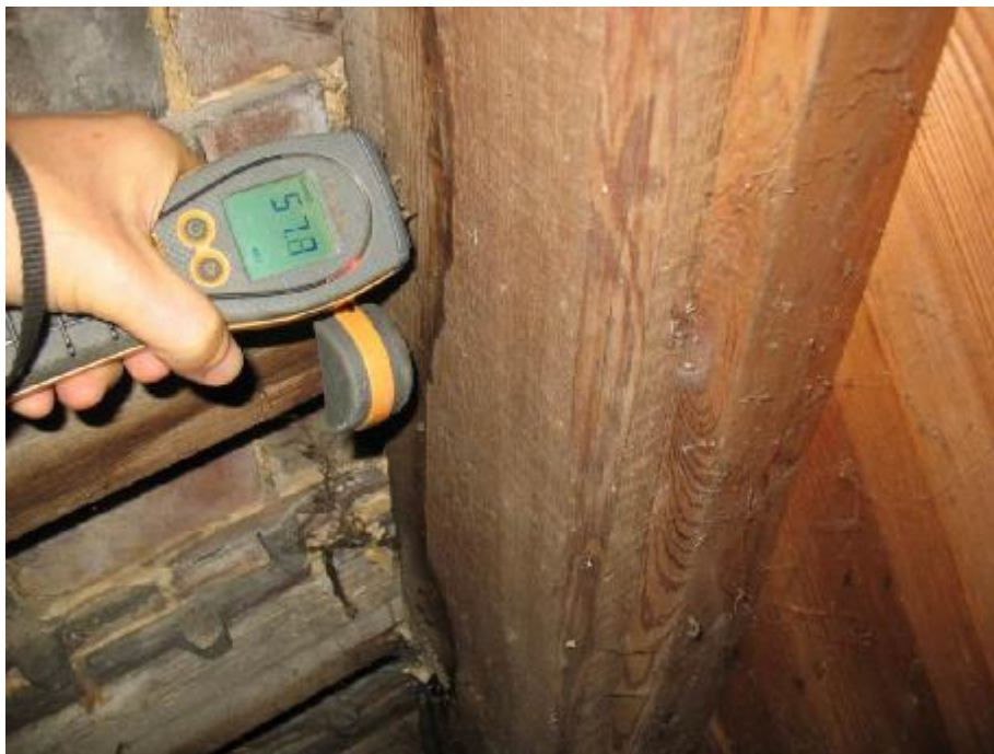
Fot.30 Badanie wykazało, że krokiew jest mocno zawilgocona.
