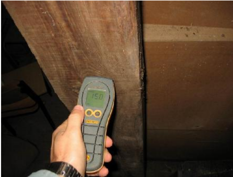
Fot.14 Słup pod płytą kalenicową. Odczyt 15 %~15% (wilgotność drewna w stanie powietrzno-suchym, zielone wskazanie urządzenia). Drewno suche
