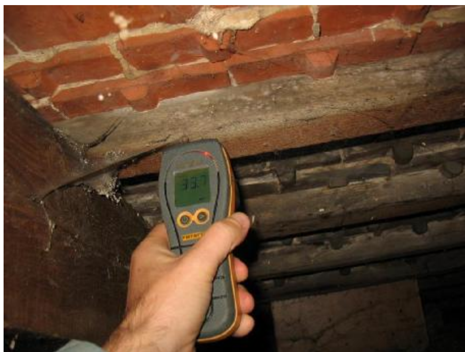
Fot.17 Badanie wykazało, że łąty w obrębie krokwi są zawilgocone . Odczyt 33,7 %>15% (wilgotność drewna w stanie zawilgoconym, czerwone wskazanie urządzenia).
