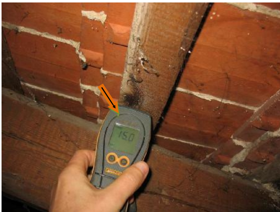
Fot.10 Łaty 6x3cm. . Odczyt 15 %~15% (wilgotność drewna w stanie powietrzno-suchym, strzałka wskazuje zielone wskazanie).
