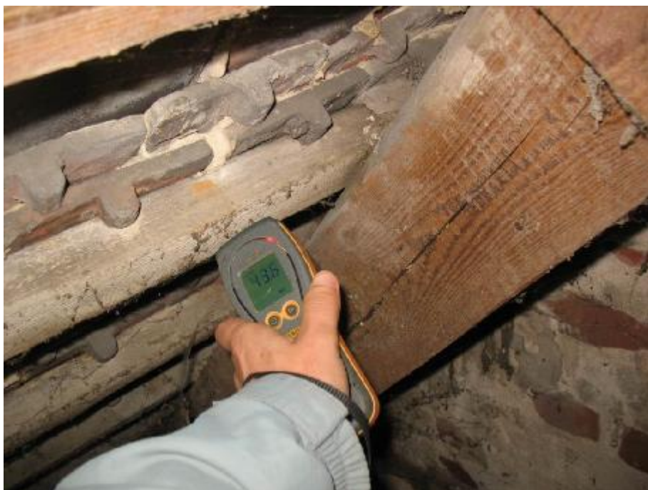
Fot.24 Badanie wykazało, że łąty w obrębie krokwi są zawilgocone . Odczyt 43,6 %>15% (wilgotność drewna w stanie zawilgoconym, czerwone wskazanie urządzenia).
