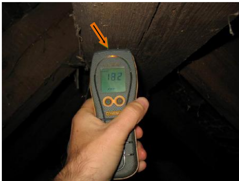
Fot.12 Płatew kalenicowa. Płatew posiada ponadnormatywne zawilgocenie. (strzałka wskazuje żółte wskazanie urządzenia). Odczyt 18,2 % > 15% (wilgotność drewna w stanie powietrzno-suchym).
