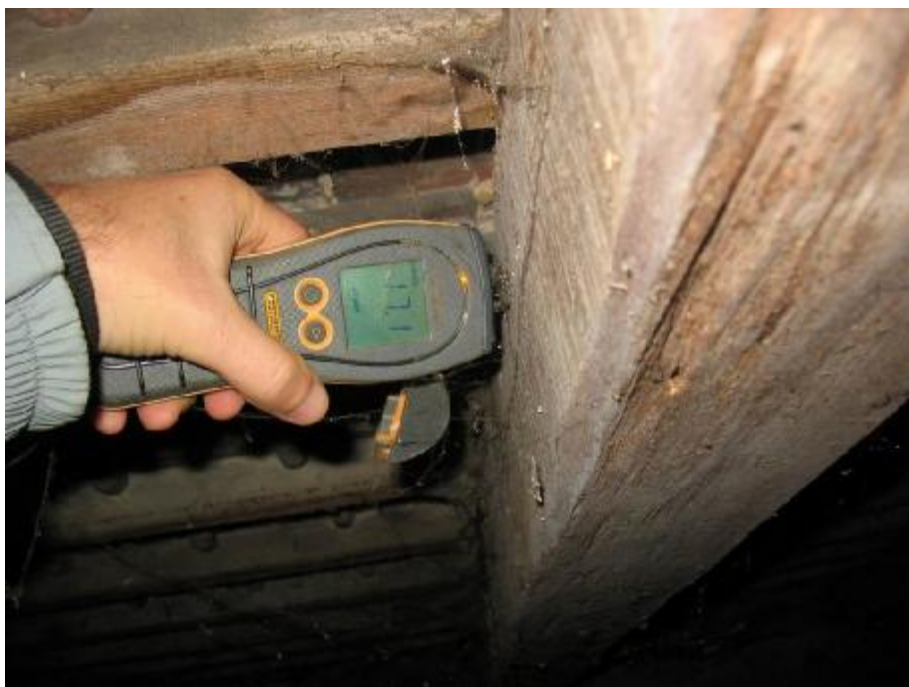
Fot.25 Badanie wykazało, że krokiew jest lekko zawilgocona (czerwone wskazanie urządzenia) . Odczyt 26 %>15% (wilgotność drewna w stanie lekko zawilgoconym, żółte wskazanie urządzenia).
