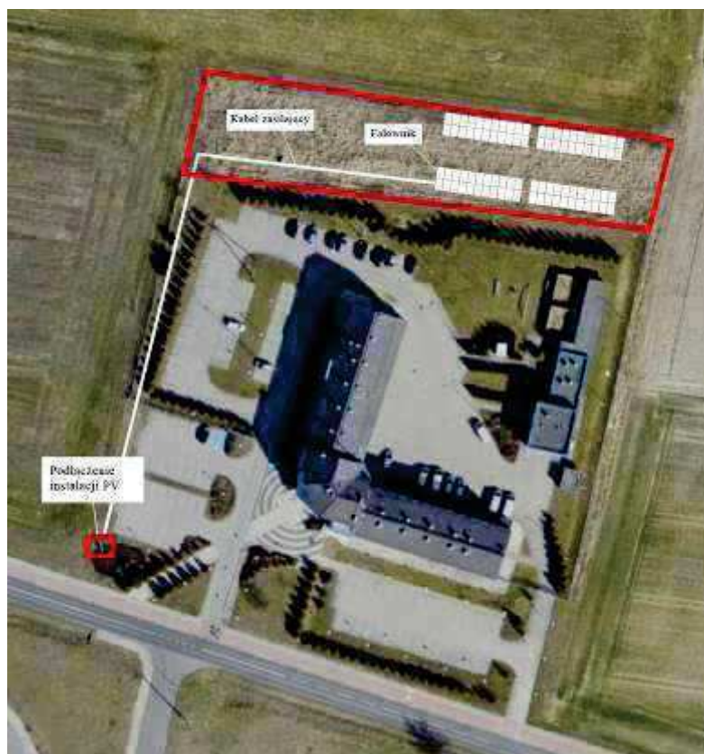
Zdjęcie nr 3 – Propozycja podłączenia instalacji fotowoltaicznej, dodatkowa rozdzielnia przy złączu energetycznym
