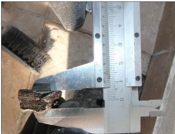
Fot 04_9. Zastosowana izolacja bitumiczna gr. ok 1cm. izolacja plastyczna, niezwiązana, wydzielająca nieprzyjemny „chemiczny” zapach.
