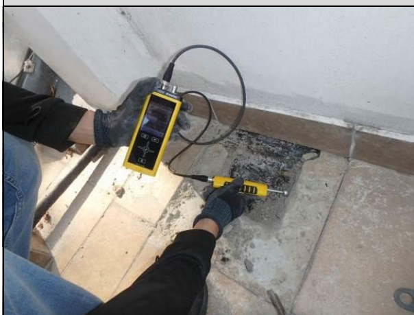
Fot. 04_5, 04_6. Pomiar wilgotności w pobliżu dolnej powierzchni szlichty 186,0 [digits] – przegroda mokra.
