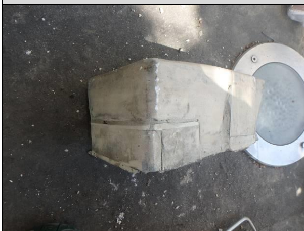
Fot_02_3. Widoczne miejscowe naprawy metodą flekowania. W miejscu flekowania nastąpiło ponowne odspojenie – z większym niż pierwotnie fragmentem skały.
